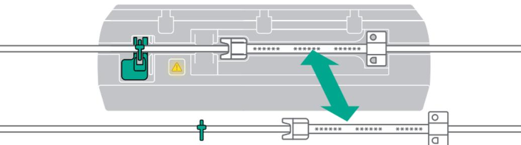
6. Frontklappe durch festes Drücken mit beiden Händen an der Frontklappe schließen. Dabei solange drücken, bis zu hören und zu fühlen ist, dass die motorisierte Verriegelung die Frontklappe schließt.
