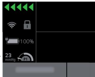
Der weiße Zeiger des Manometers zeigt den aktuellen Druck im Infusionssystem an. Je niedriger die gewählte Druckstufe ist, desto größer wird der graue Bereich des Manometers. Sobald der Zeiger in diesen grauen Bereich gelangt, wird ein Druckalarm ausgelöst.
