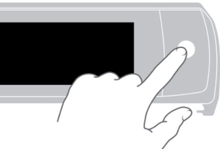
1. **Frontklappe-auf**-Taste drücken, um die Öffnung der Frontklappe einzuleiten
