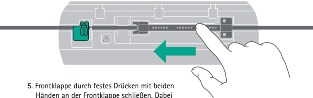
5. Frontklappe durch festes Drücken mit beiden Händern an der Frontklappe schließen. Dabei solange drücken, bis zu hören und zu fühlen ist, dass die motorisierte Verriegelung die Frontklappe schließt.
