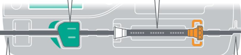
Sicherstellen, dass die Infusionsleitung sich in der rechten und linken Nut befindet.
