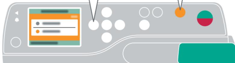
1. Um den Leitungswechsel durchzuführen, die laufende Infusion durch Drücken der
