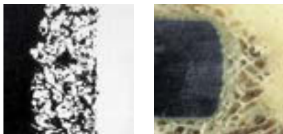
Plasmapore® Querschnitt und Knochenkontakt
